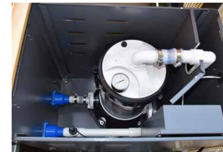
Unità filtrante con riscaldatore dell'acqua integrato
